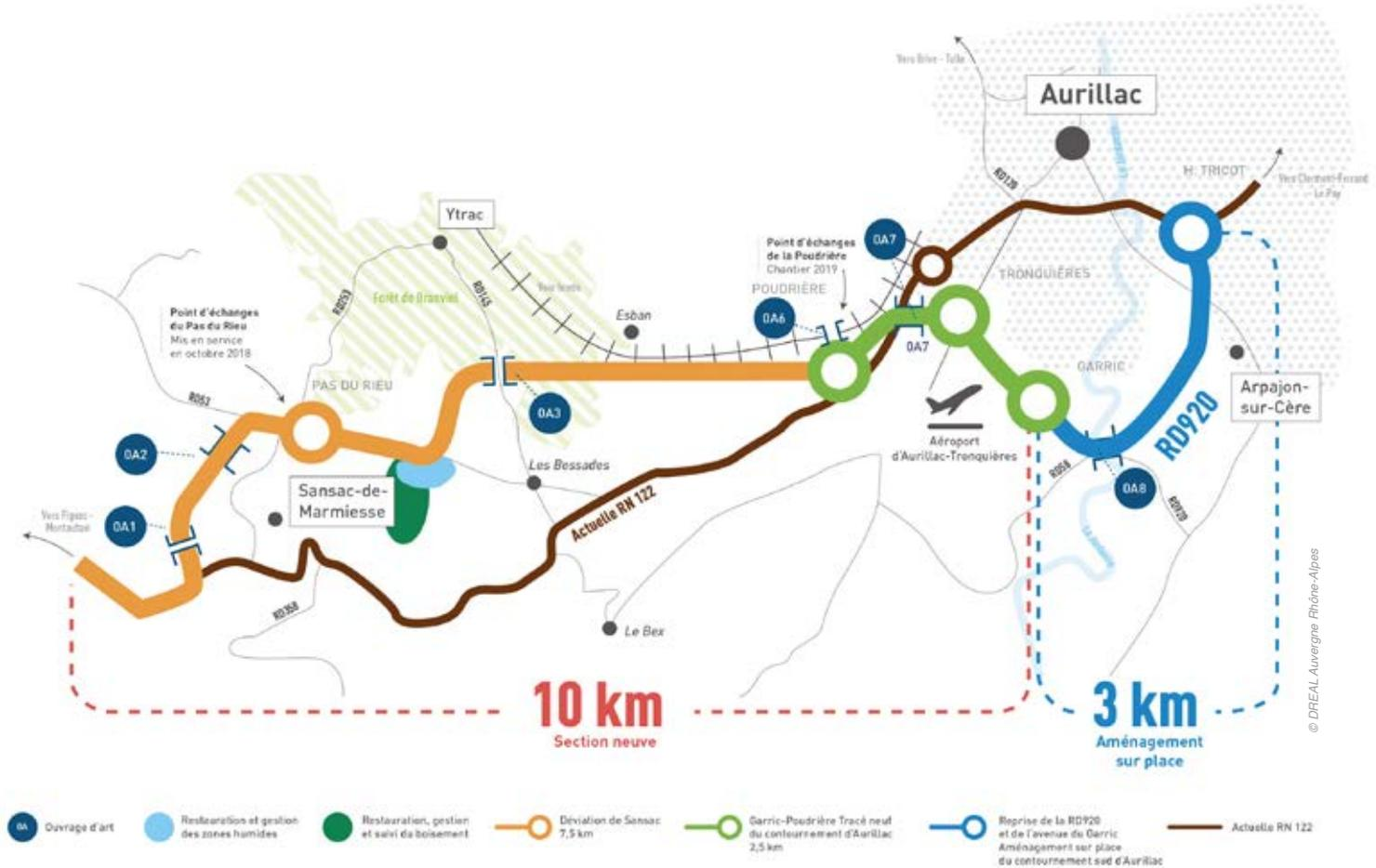
RN122 (qui a été légèrement déviée) via un nouvel ouvrage d'art. Des interventions spécifiques ont été nécessaires pour la construction de ce pont routier, la proximité avec l'aéroport d'Aurillac-Tronquières ne permettant pas l'utilisation d'engins de levage. Un second bassin de rétention des eaux pluviales a été créé dans cette zone.
